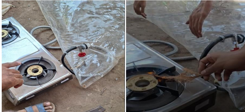
Gambar 5. Uji nyala api reactor biogas pada kompor terinstal
