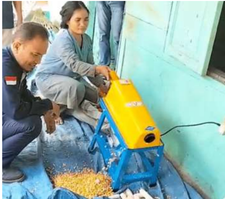
Gambar 3. Uji Coba Pengoperasian Mesin Pemipil Jagung Tepat Guna oleh Petani Mitra
